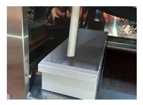
• Si la bandeja cuenta con tubería caliente para evaporación, retirarla no será posible y la eliminación de agua residual se hará de forma automática.
