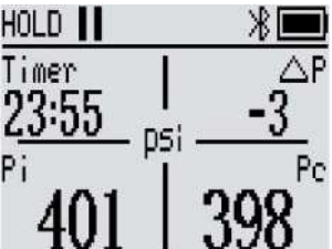
Imagen 3 - Interfaz de la prueba de estanqueidad
