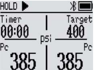
Imagen 2 - Interfaz de la prueba de estanqueidad
